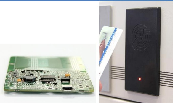
-OEM: beépíthető, tokozás nélküli kivitel
