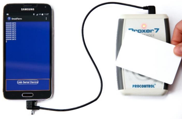
USB soros port / billentyűzet emuláció, kártyaolvasás okostelefonba speciális OTG kábellel
