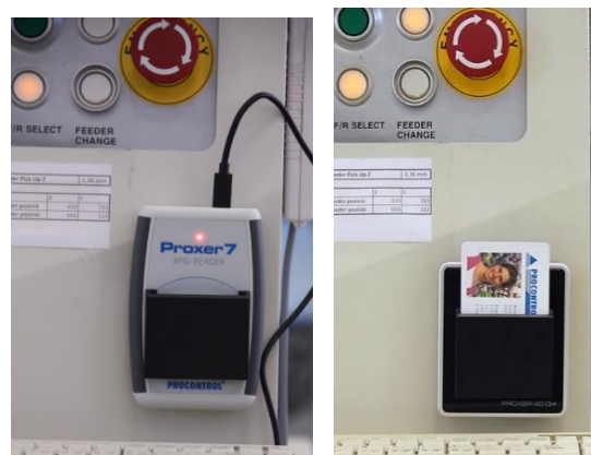
Proxer7, Proxer23-CH: fali /gép oldalára szerelhető kivitel kártyazsombbal
