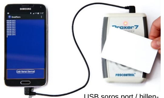
USB soros port / billentyűzet emuláció, kártyaolvasás okostelefonba speciális OTG kábellel
